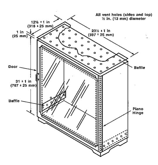
FIGURE B-1. SKETCH OF BUNSEN BURNER TEST CABINET
